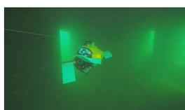
**Un robot sous-marin inspiré d'une tortue.** Les ingénieurs de l'université de Tallinn se sont inspirés d'une tortue pour réaliser ce robot destiné à aider les archéologues sous marins. En lieu et place des hélices des palmes sensé offrir plus d'aisance dans les déplacements. Une aubaine pour aller plonger sur les épaves de la seconde guerre mondiale qui tapissent le fond de la
